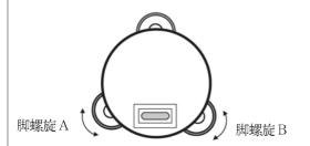
平行于某一对脚螺旋A、B的连线。再旋转脚螺旋A、B,使管水准器气泡居中。
